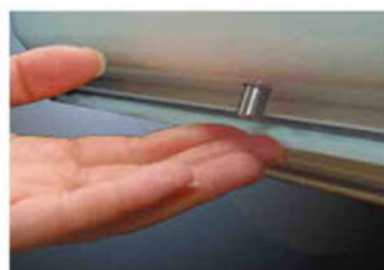
ロックピンを押し、面板のロックをワンタッチで解除。
